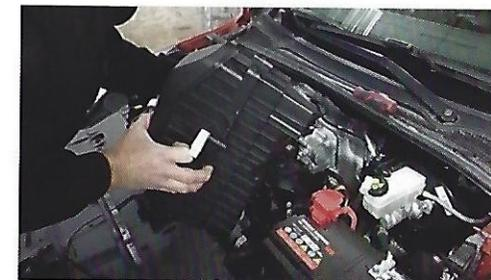
Enlevez le filtre à air, en le déboîtant et en déconnectant le tuyau d'arrivée d'air frais en façade.
