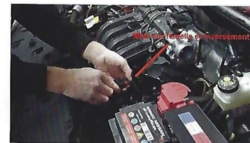
Branchez la sonde de température sur le connecteur 2 broches venant du boîtier et fixez la cosse sur un boulon du support de levage du moteur.
