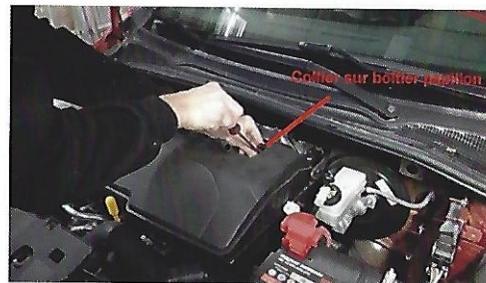
Avec un gros tournevis, desserrez le collier de fixation au volet papillon.
