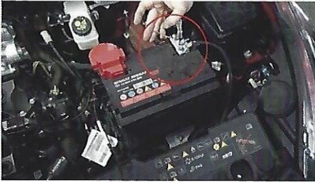
Raccorder la masse du boîtier (cosse dorée) sur la borne négative de la batterie avec un écrou de 6 et une clef de 10.
