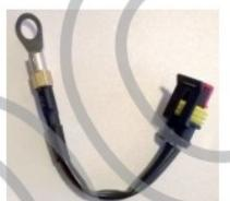
La sonde de température se branche sur le connecteur deux fils venant du boîtier.
